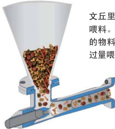
文丘里喷射器不需要均匀喂料。当输送流动性很好的物料时, 喷射器不会应过量喂料而堵塞。
