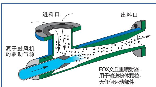
在输送过程中，文丘里喷射器压缩固体物料与空气的混合物，由此提供足够的压力来弥补下流管道的压力降。喷射器有三种连接口：
