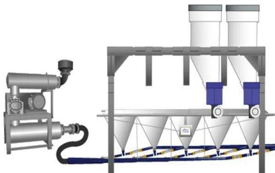
一台罗茨风机驱动 5 台 FOX 文丘里喷射器，来输送 5 台粉尘收集器的粉体。没有回气，无需维修，没有运动部件
