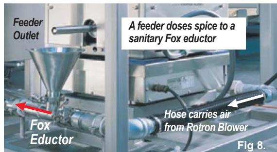
FOX 文丘里喷射器安装于许多螺杆喂料器出口下面。不会有回气进入喂料器。典型应用有燃烧，污染控制的助剂及食品行业的香料。
